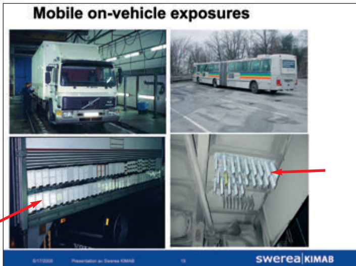
Эти пластины крепят к кузовам автобусов и грузовиков, чтобы изучить влияние коррозионных факторов на определенных маршрутах движения.
