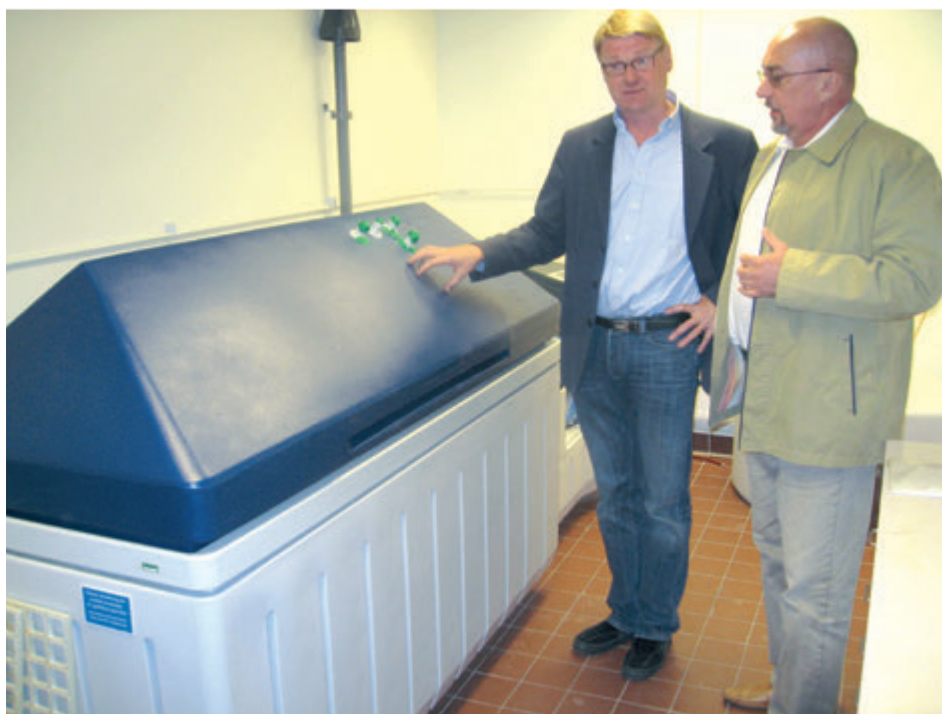
Камера соляного тумана для ускоренных коррозионных испытаний
