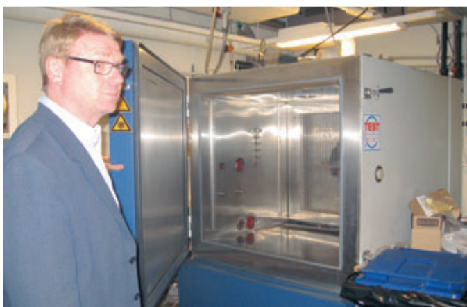
Климатическая камера для ускоренных коррозионных испытаний
