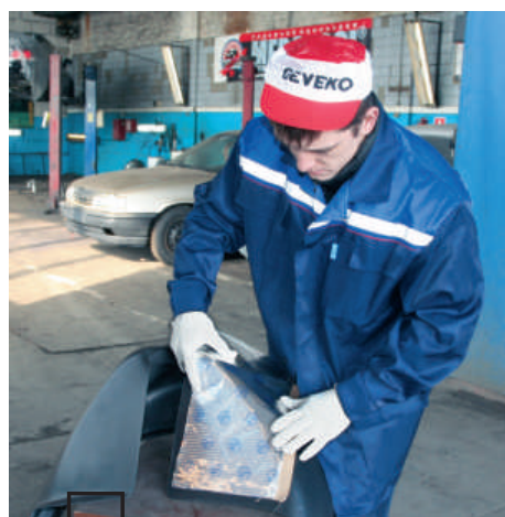
Оригинальная услуга «НИКОРАВТО» — уклейка части подкрылков. Теперь удары гравия будут не слышны.
