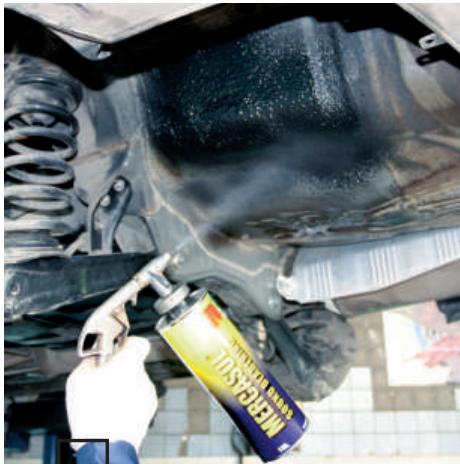
Защищаем зону под багажником. Mercasol Sound Stop наносится стандартным способом.
