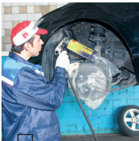
□ Обработка арок — обязательная операция при использовании Mercasol Sound Stop.
