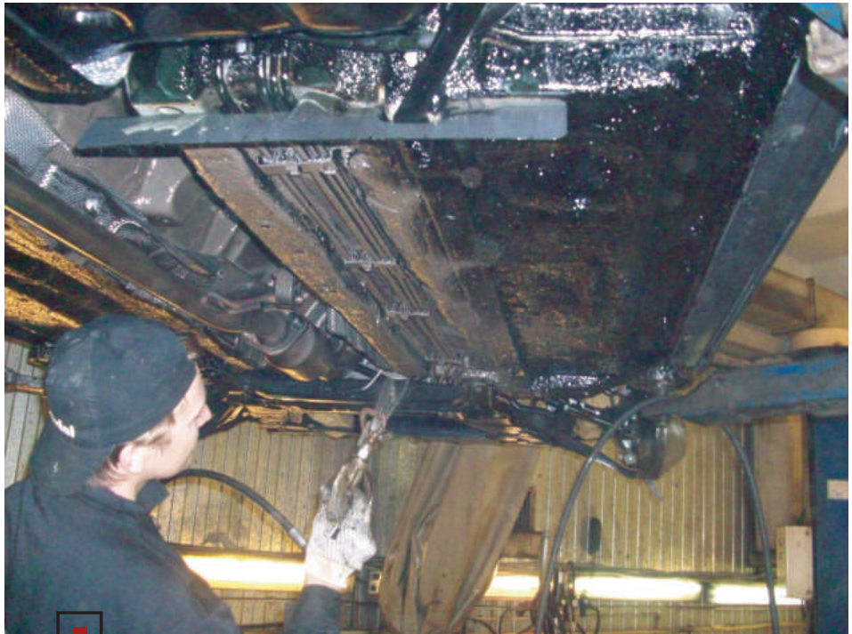
Распыление материалов Noxudol без растворителя мало отличается от нанесения традиционных битумных препаратов. Время высыхания у них дольше, но пленка тоньше при более высоком качестве защиты.
