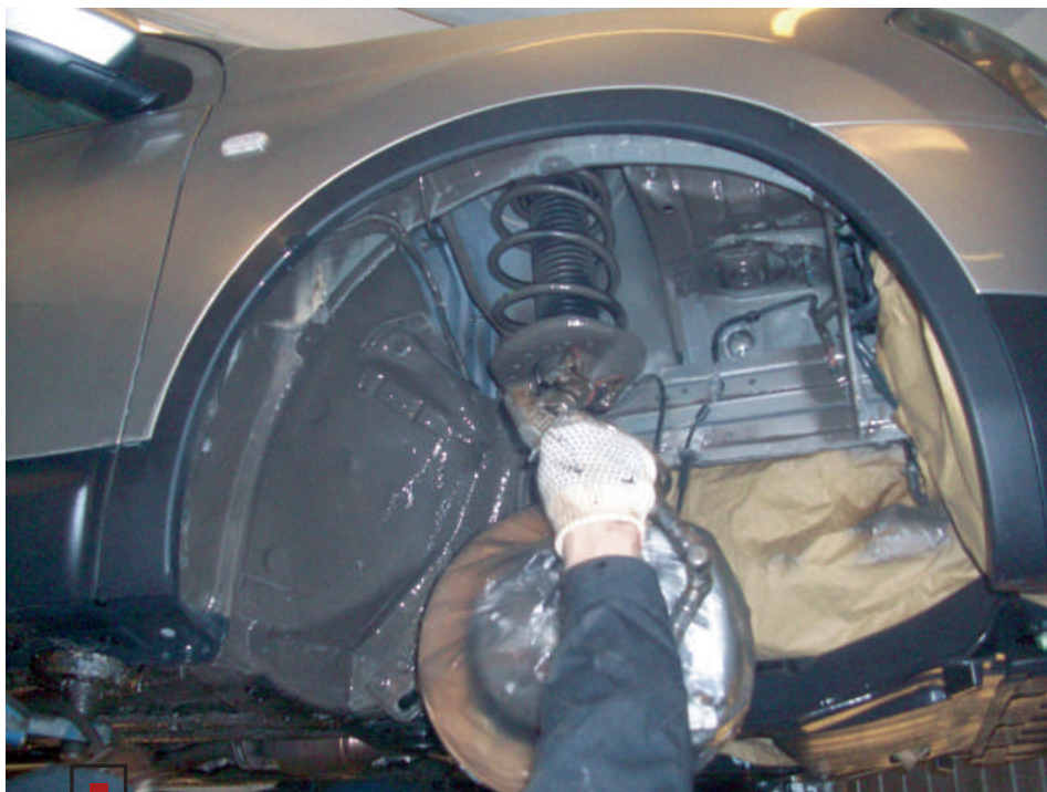
Безрастворительными материалами Noxudol защищают и арки, и днище кузова. Их удобно использовать при больших объемах работ, когда защита автомобилей поставлена на поток.
