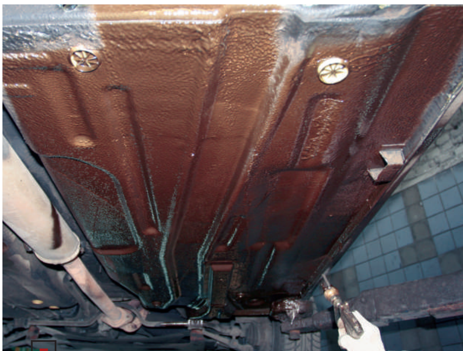
И снова Mercasol. Так выглядит пленка нового препарата для днища, входящего в систему Microshield. Полимер содержит уникальный наполнитель — полимерные микросферы.
