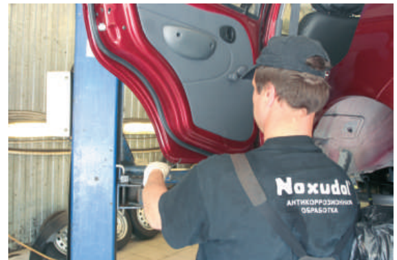
Двери обрабатываются через технологические и дренажные отверстия.
