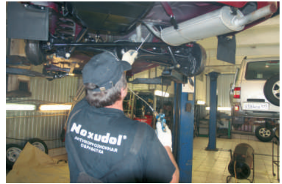
Приемы работы с Mercasol и Noxudol при защите полостей не отличаются друг от друга.
