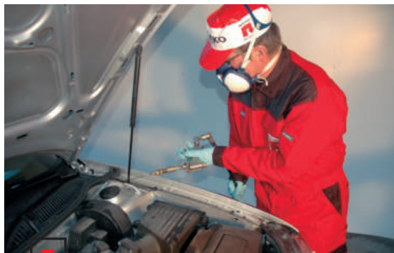
Завершающий этап защиты — обработка в положении «с пола» полостей и стыков в багажнике и подкапотном пространстве.
