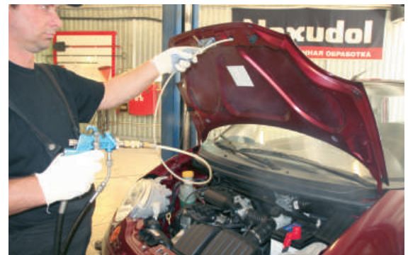
Завершающий этап защиты — обработка в положении «с пола» полостей и стыков в багажнике и подкапотном пространстве.
