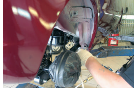
Пороги обрабатываются одинаково: вводится насадка, включается «факел распыления», после чего насадка медленно вытягивается из порога.
