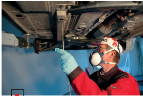
Приемы работы с Mercasol и Noxudol при защите полостей не отличаются друг от друга.
