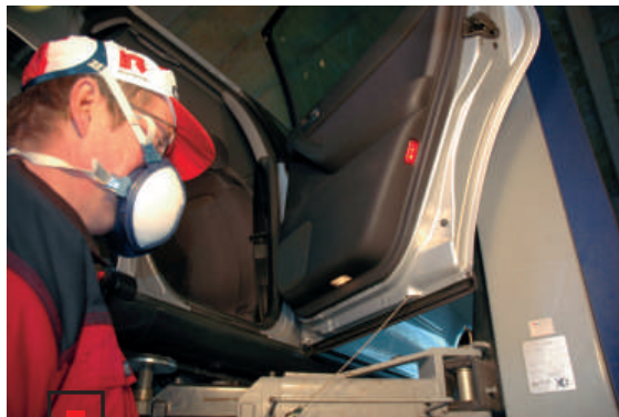
Двери обрабатываются через технологические и дренажные отверстия.
