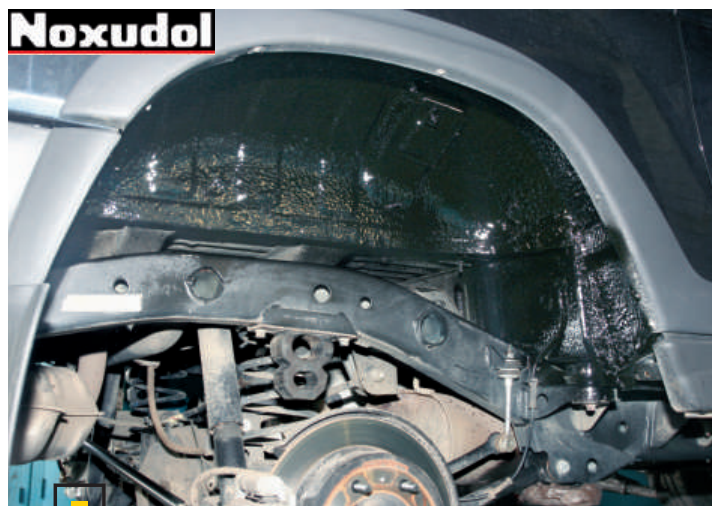
■ Покрытие Noxudol Autoplakon. Распыление воздушным способом
