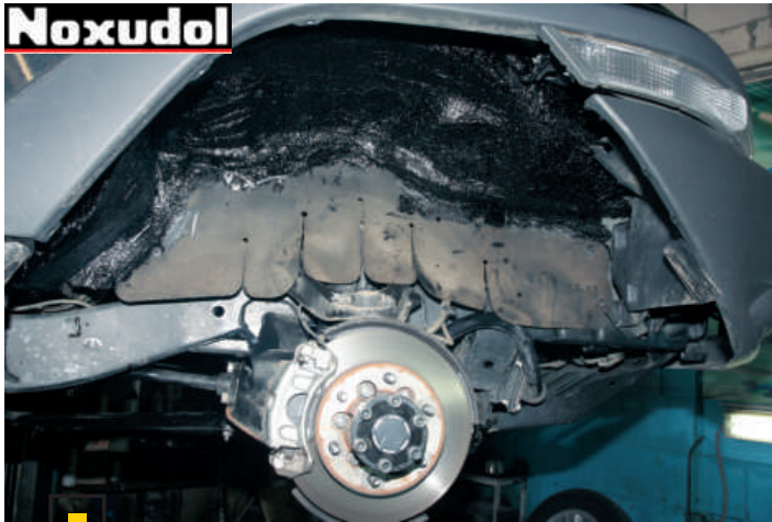
Покрытие Noxudol Autoplaston, нанесенное шпателем и кистью
