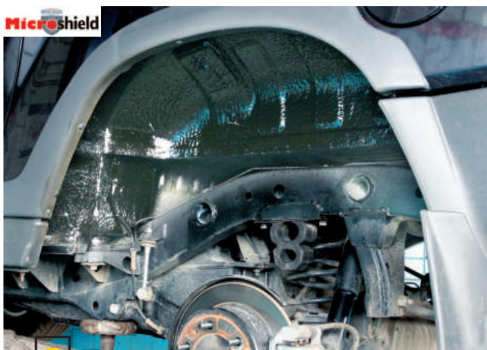
■ Пленка Merccasol 4, нанесенная шпателем и покрытая сверху распыляемым составом
