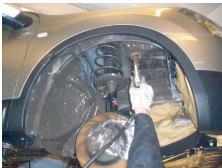
Материалы для защиты арок не только предохраняют металл от «пескоструйки» и коррозии, но и поглощают шум.
