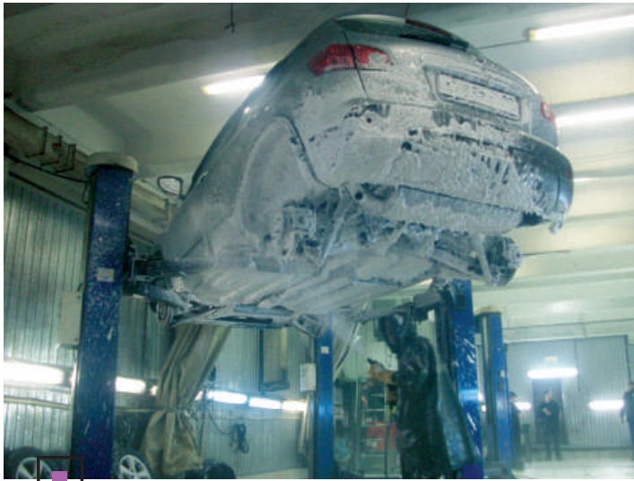
■ Перед антикоррозионной обработкой автомобиль необходимо вымыть, в том числе и снизу.
