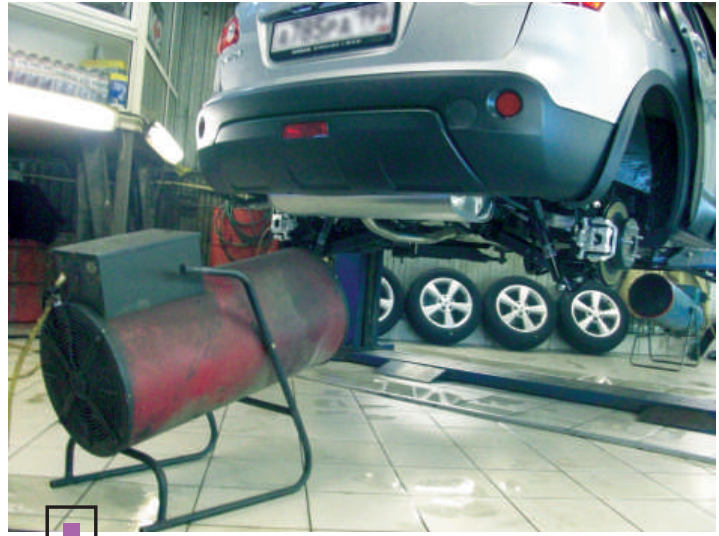
■ После мойки — тщательная сушка, например, с помощью тепловых пушек.
