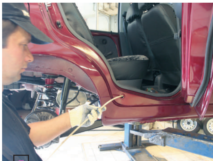
■ В полостях распыляются «легкие», подвижные препараты с ингибиторами коррозии.
