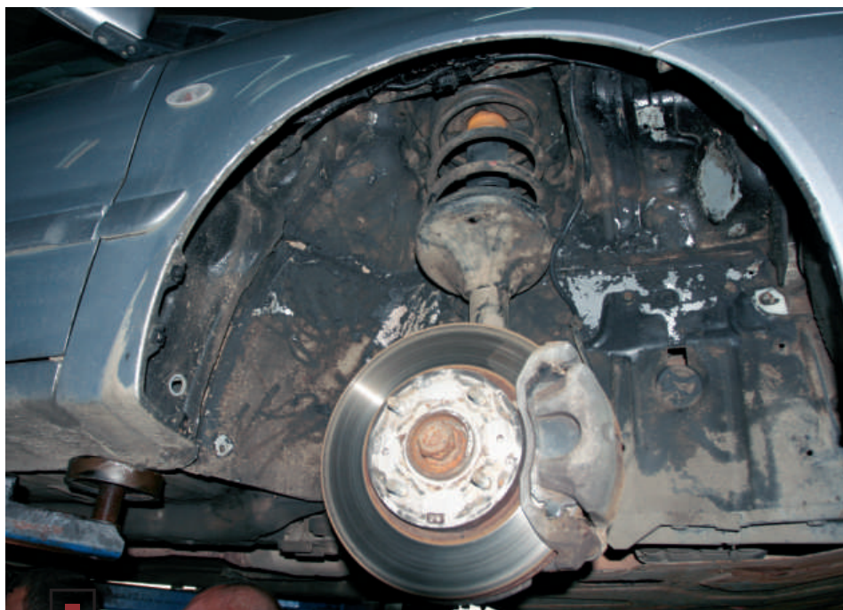
Защита арок имеет повреждения.
