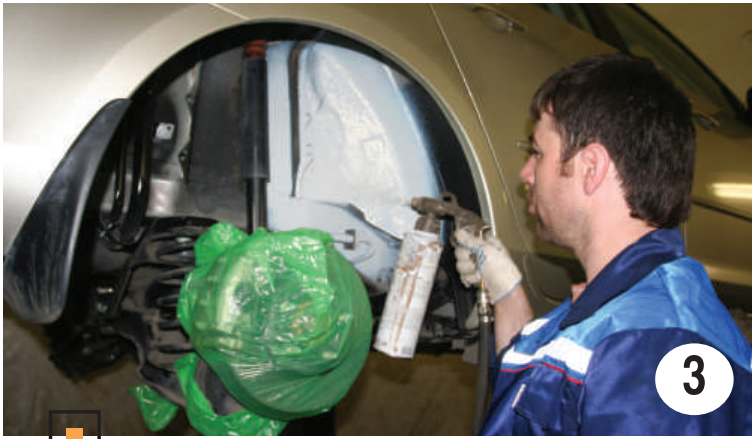
3 Распыление противозумной мастики Noxudol 3100 проводится обычным способом — как нанесение антикоров
