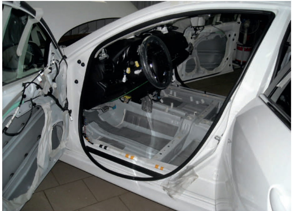
Самый трудоемкий процесс в работе с Noxudol 3100 — снять навесное оборудование салона, а затем смонтировать его обратно
