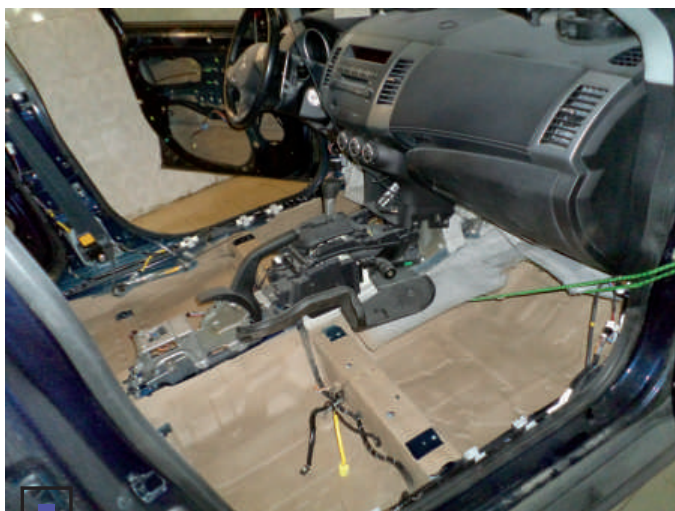
Для обработки напыляемой мастики требуется разборка салона
