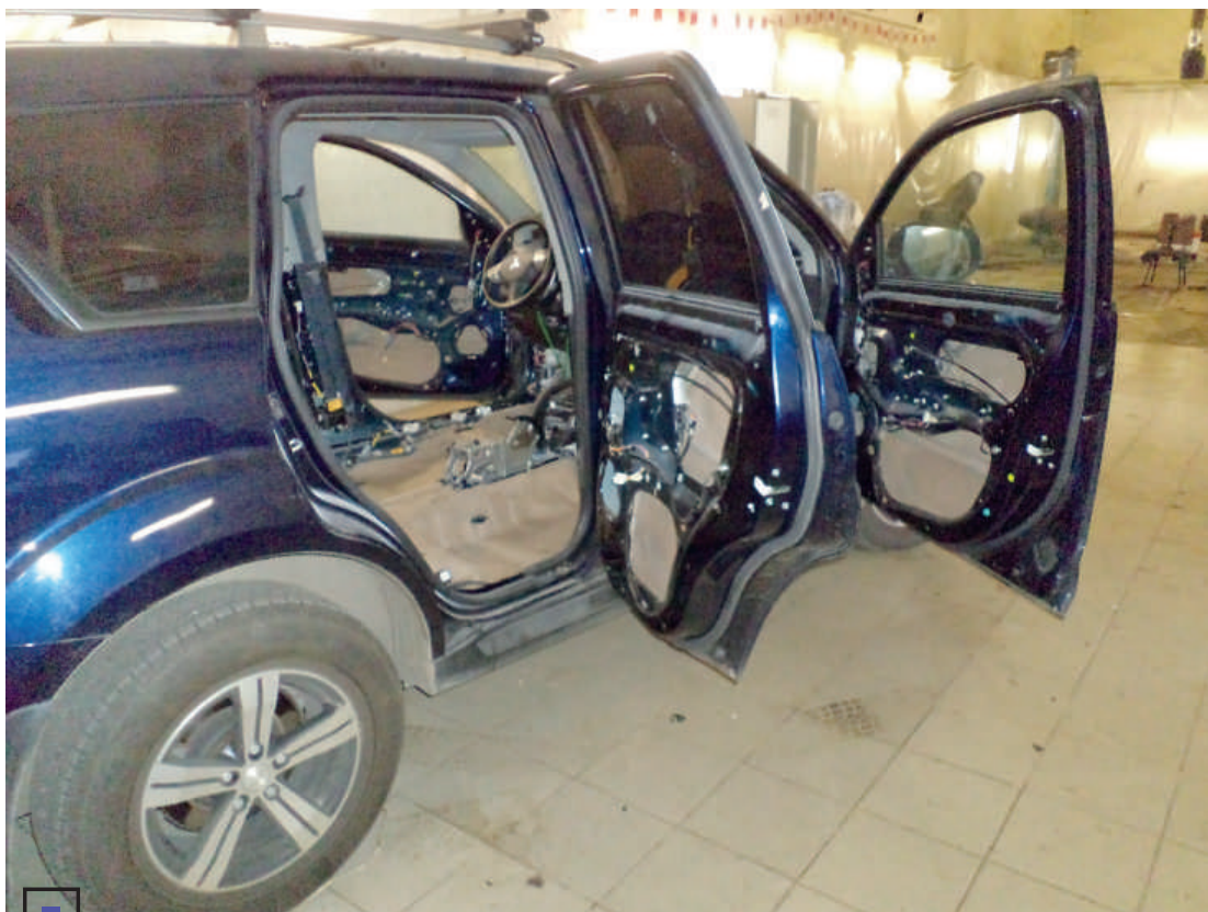
Обработка автомобиля напыляемой мастикой. Здесь ее можно наблюдать в полостях дверей, на внутренней поверхности днища и в колесных арках
