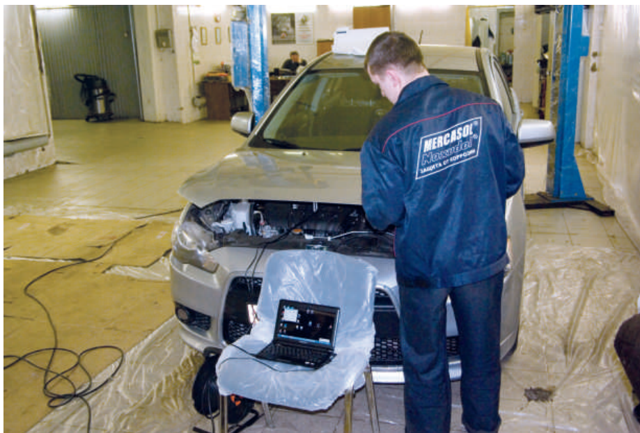
Весной этого года Lancer был обработан напыляемой мастикой Noxudol 3100 с замерами шумовых характеристик «до» и «после» обработки
