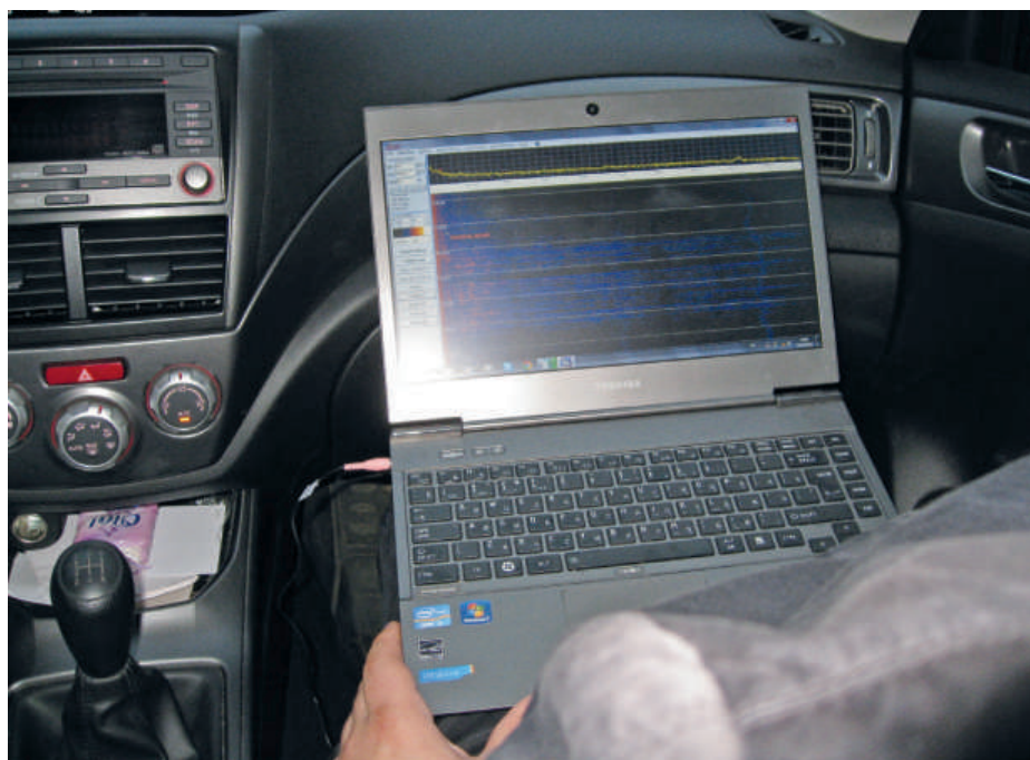
Компьютер с внешним микрофоном и программой-анализатором спектральных характеристик позволяет отследить изменение «картины» звука при различных режимах эксплуатации
