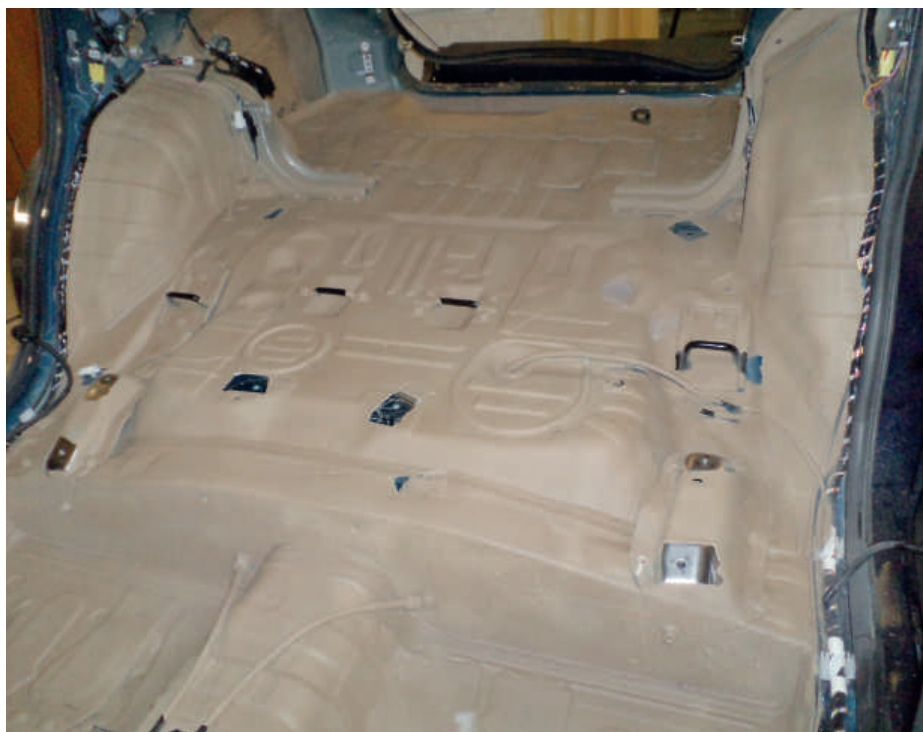
Салон разобран и обработан. Вид со стороны водительского места на багажное отделение
