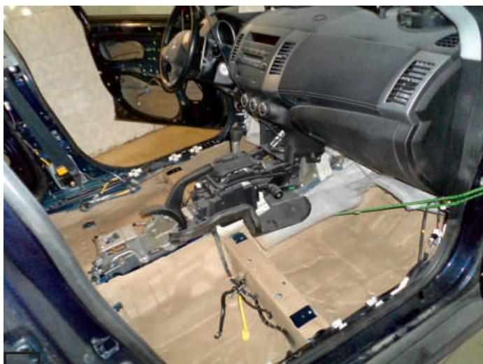
Для нанесения противозумной мастики салон частично разбирается
