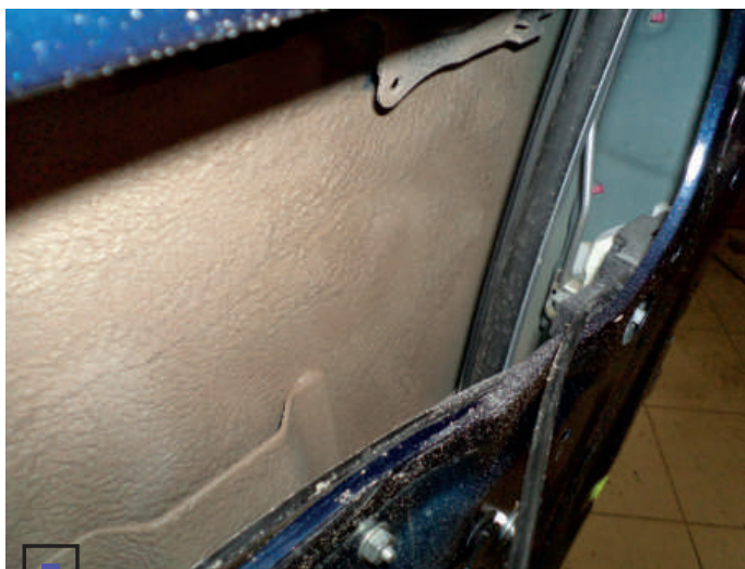
Эта пленка решает несколько задач: шумоизоляция, защита от коррозии, теплоизоляция, препятствие образованию конденсата
