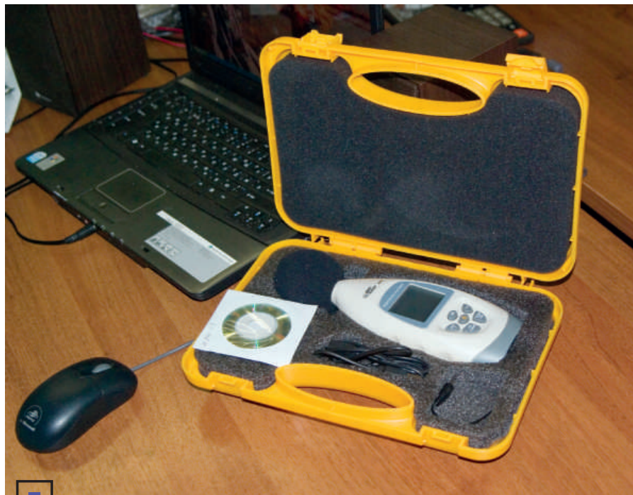
Цифровой измеритель уровня звука (шумомер) AR-834
