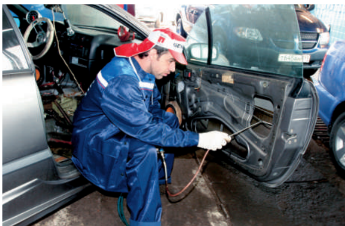
Частичный демонтаж внутренней обшивки салона и дверей позволяет сделать высококачественную обработку.
