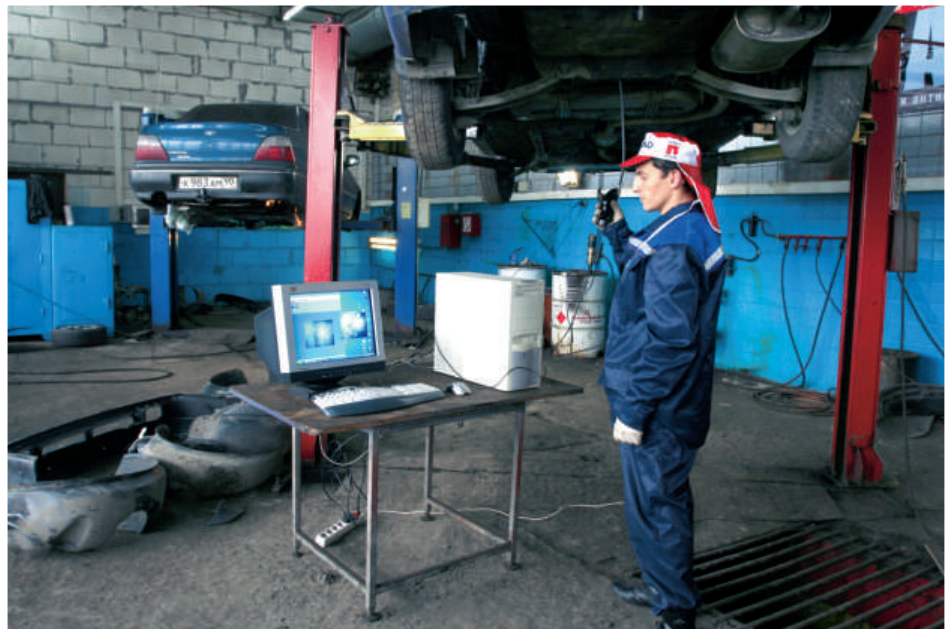
Диагностика состояния кузова с помощью бороскопа
