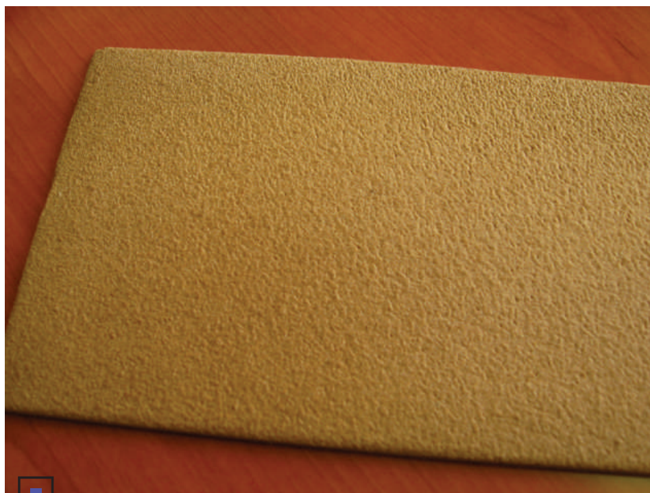
□ Так выглядит протившумная напыляемая пленка Noxudol 3100
