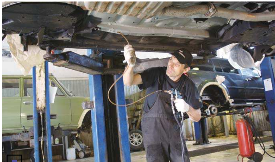
Обработка полостей кузова Noxudol 700 методом воздушного распыления. Используются заводские технологические и дренажные отверстия
