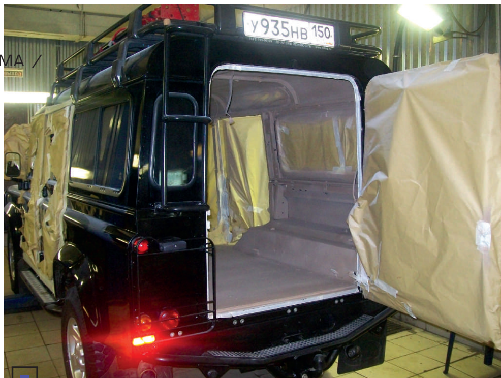
Пример обработки кузова напыляемой протившумной мастикой
