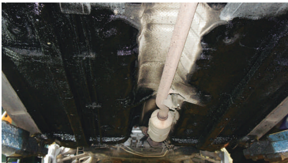
Днище Mitsubishi Outlander после обработки Mercasol Sound Stop. Материал обеспечивает двойную защиту — и от шума, и от коррозии
