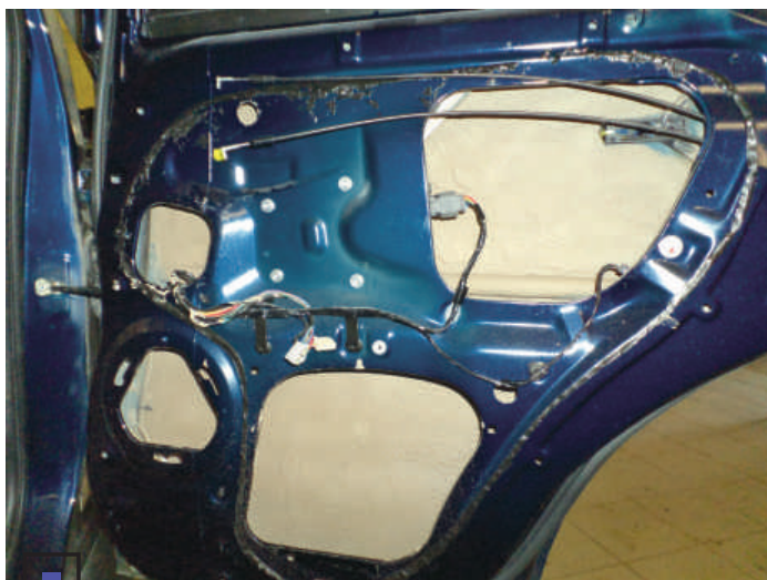
Защита наносилась на внутренние поверхности дверных панелей...
