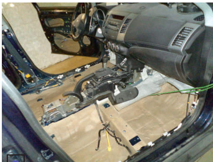
...а также на пол и коробка кузова, для чего потребовалась разборка салона
