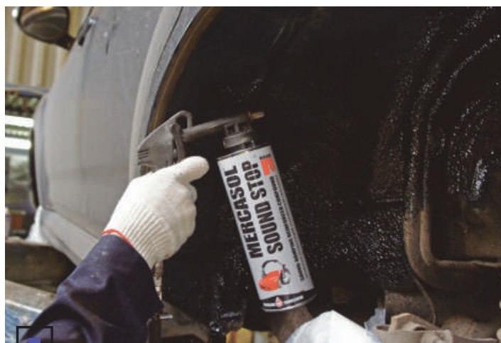
Работать с Mercasol Sound Stop удобно. Технология нанесения — как при обычной антикоррозионной защите
